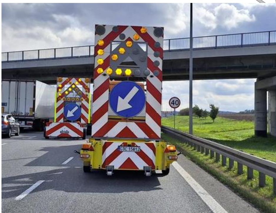
Rys. 6.6.10. Przykład systemu TMA/TTMA (U-309 +U-107+U-210) z samochodem ciężarowym
