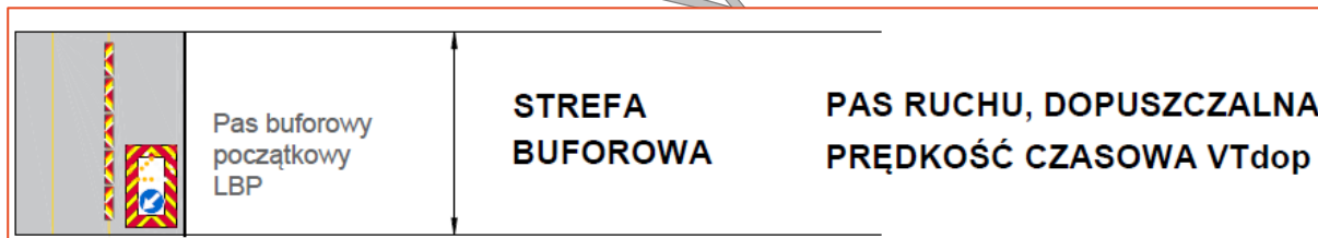
Rys. 7.1.10 Schemat ogólny lokalizacji strefy buforowej początkowej wraz z oznakowaniem
