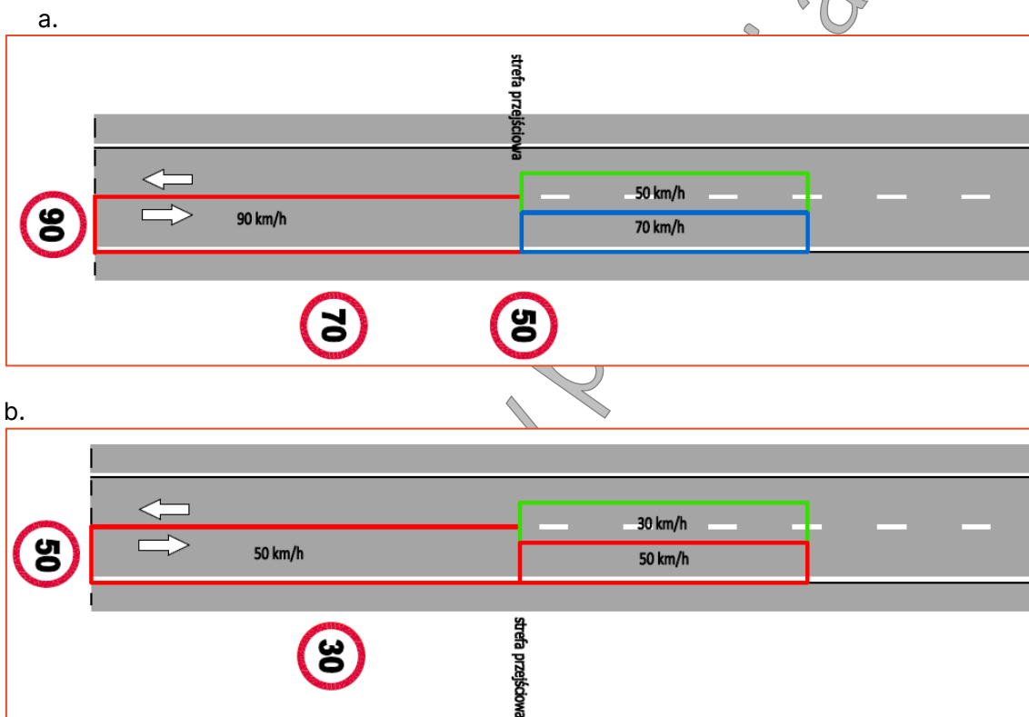
Rys. 7.1.2 Zasady przyjmowania prędkości do projektowania parametrów czasowej organizacji ruchu w strefie ostrzegawczej i buforowej obszaru robót drogowych na jezdni dwukierunkowej: a) droga zamiejska, b) ulica
